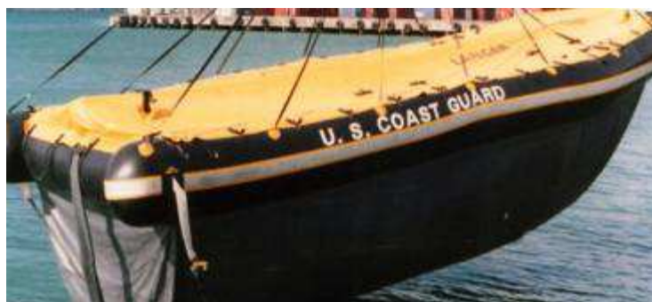
Slika 38. Barža kapaciteta od 25 do 50 m 3
