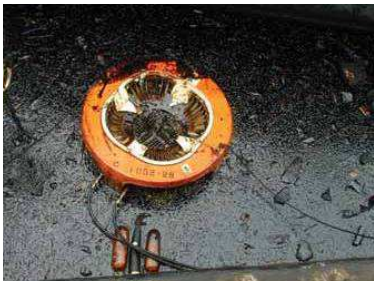
Slika 13. Mali oleofilni disk, pogodan za ulja srednjeg viskoziteta. Ulje se drži na rotirajućim diskovima kako bi se istriglo u korito za pumpanje u skladište. Zahtijeva odgovarajuću pumpu i hidraulično napajanje
