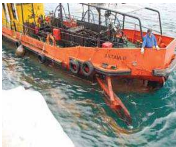
Slika 12. Samohodni skimer sa pregradom za upotrebu u lukama i priobalnim vodama.
