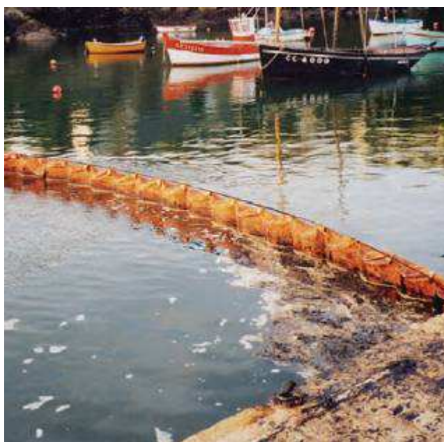
Slika 25. Ogradni nosač (brana) koji odbija ulje od vezanih plovila
