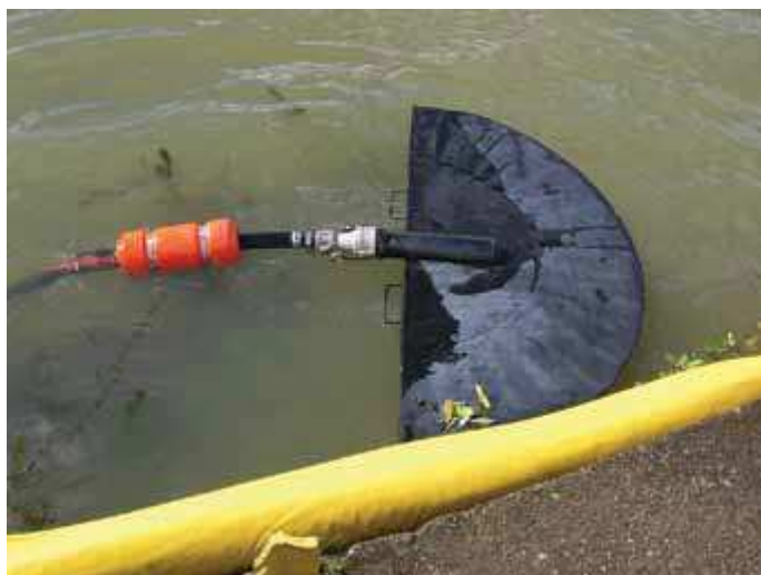
Slika 22. Fiksni skimer za vakuum priključen na vakuum pumpu
